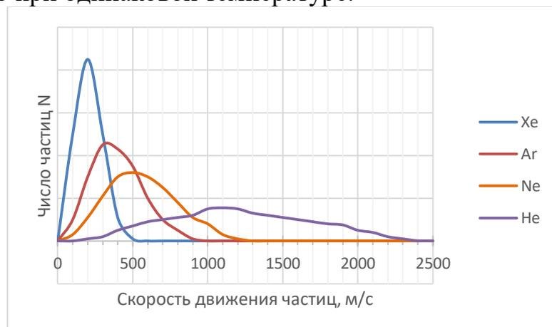
График Б – Распределение числа частиц различных газов по скоростям.
